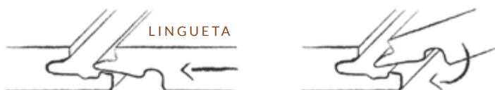
Figura 8. Instalação por meio do sistema click de travamento
