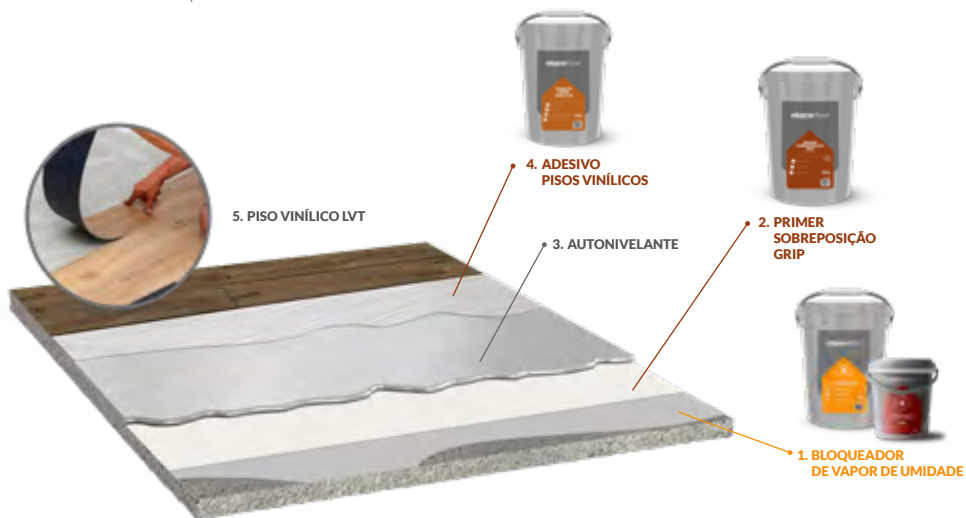
Figura 4. Etapas do processo de utilização dos insumos, contrapiso (cimentício ou cerâmica) térreo
