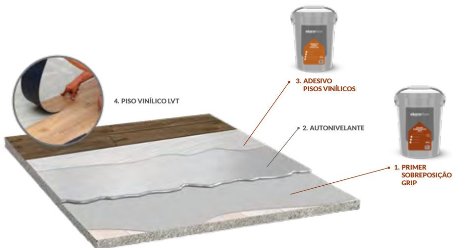
Figura 6. Etapas do processo de utilização dos insumos, contrapiso cerâmico, porcelanato ou pedras naturais em pavimento superior
