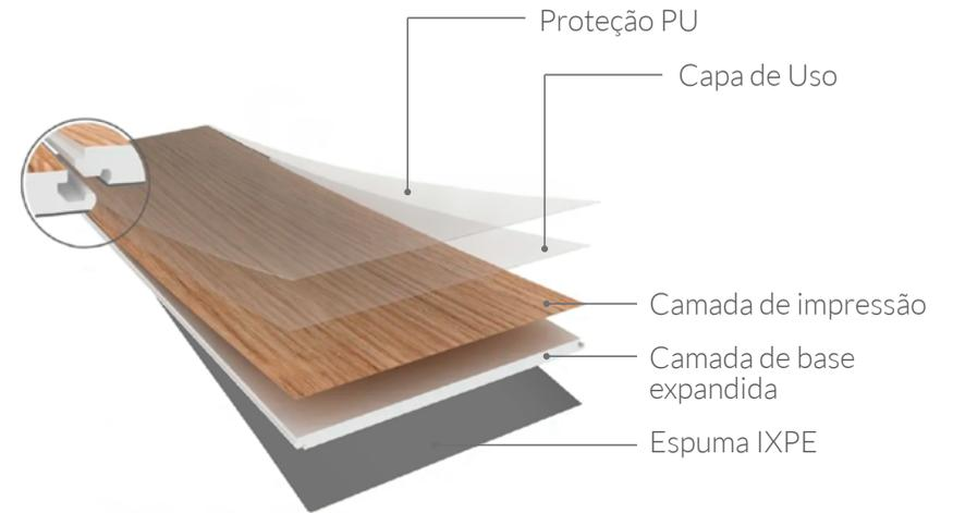
**Figura 3. Camadas do revestimento vinílico heterogêneo AUTOPORTANTE**
