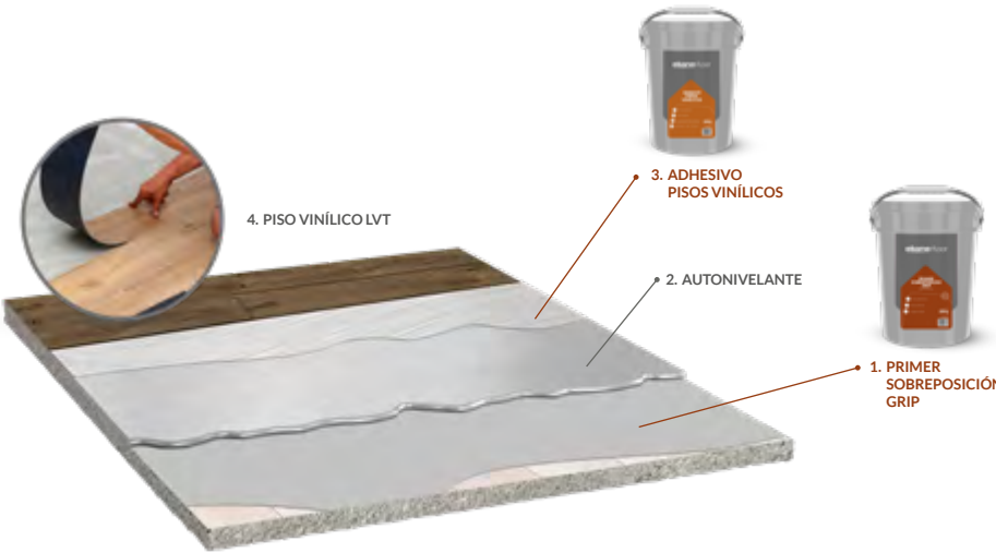
Figura 6. Etapas del proceso de utilización de insumos, contrapiso cemento, porcelanato o piedras naturales en piso superior
