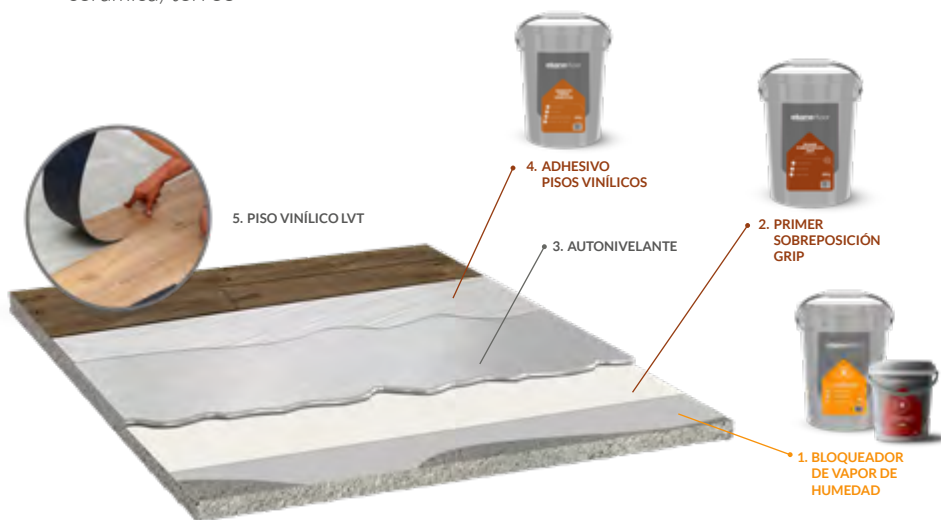
Figura 4. Etapas del proceso de utilización de insumos, contrapiso (cemento o cerámica) térreo
