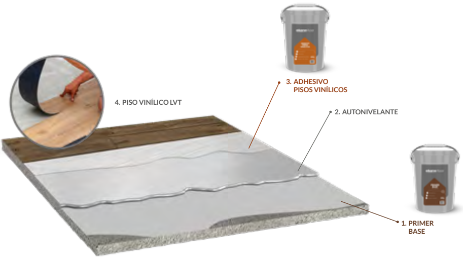
Figura 5. Etapas del proceso de utilización de insumos, contrapiso cemento en pavimento superior
