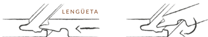
Figura 7. Sistema de encaje de revestimiento de vinilo SPC
